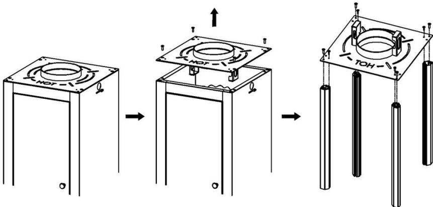
Etapa 3 : use 4 parafusos Allen escareados M6\*16 para travar a divisória do meio no corpo do forno .
