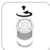
Rode a tampa inferior no sentido contrário ao dos ponteiros do relógio e retire o filtro.
