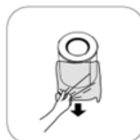
Retire o saco de embalagem do filtro e volte a instalar o filtro.
